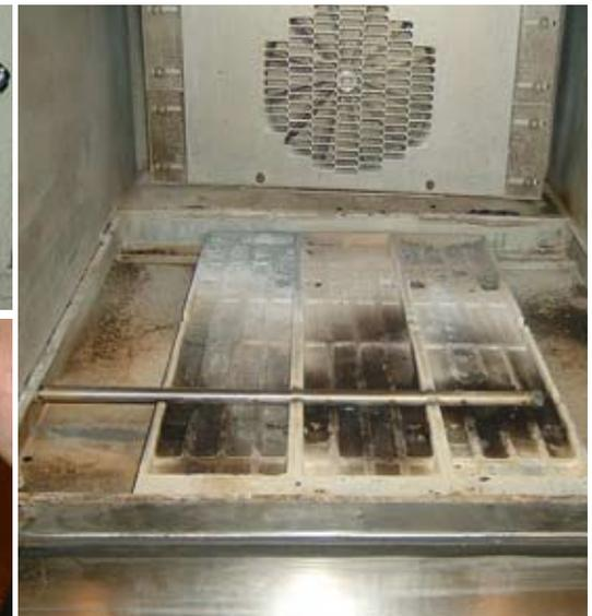
Der Backraum nach Entfernen der Abdeckbleche und Freilegung des Düsenstocks. Es sind nur Brandrückstände und ein leichter, dünner, emulsionsähnlicher Kalkfilm an den Seiten und an der hinteren Aufkantung zu erkennen.
