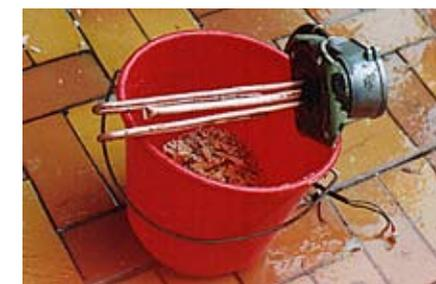
Boilerflansch nach Reinigung mithilfe von Wasserstrahl und Bürste
