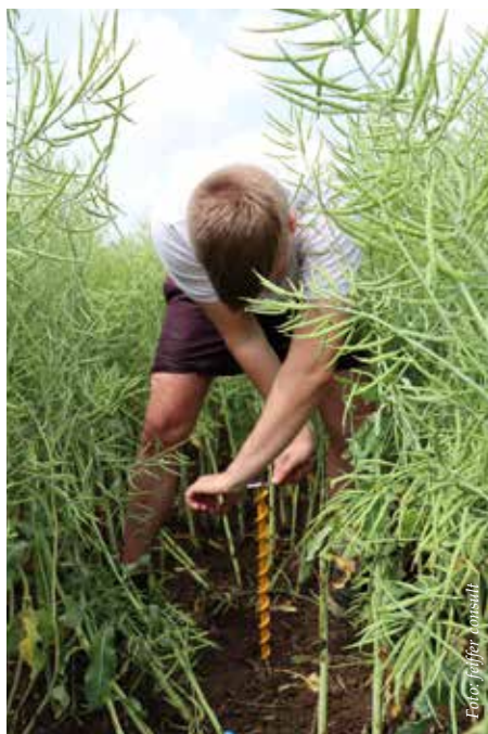
Ausbringen von Bodenfeuchtesensoren in jeder Variante.
