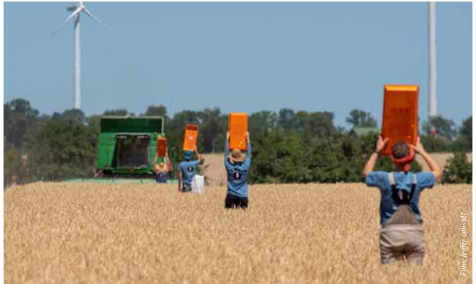
Prüfung der Druscheigenschaften (Leistung, Verluste, Diesel).
