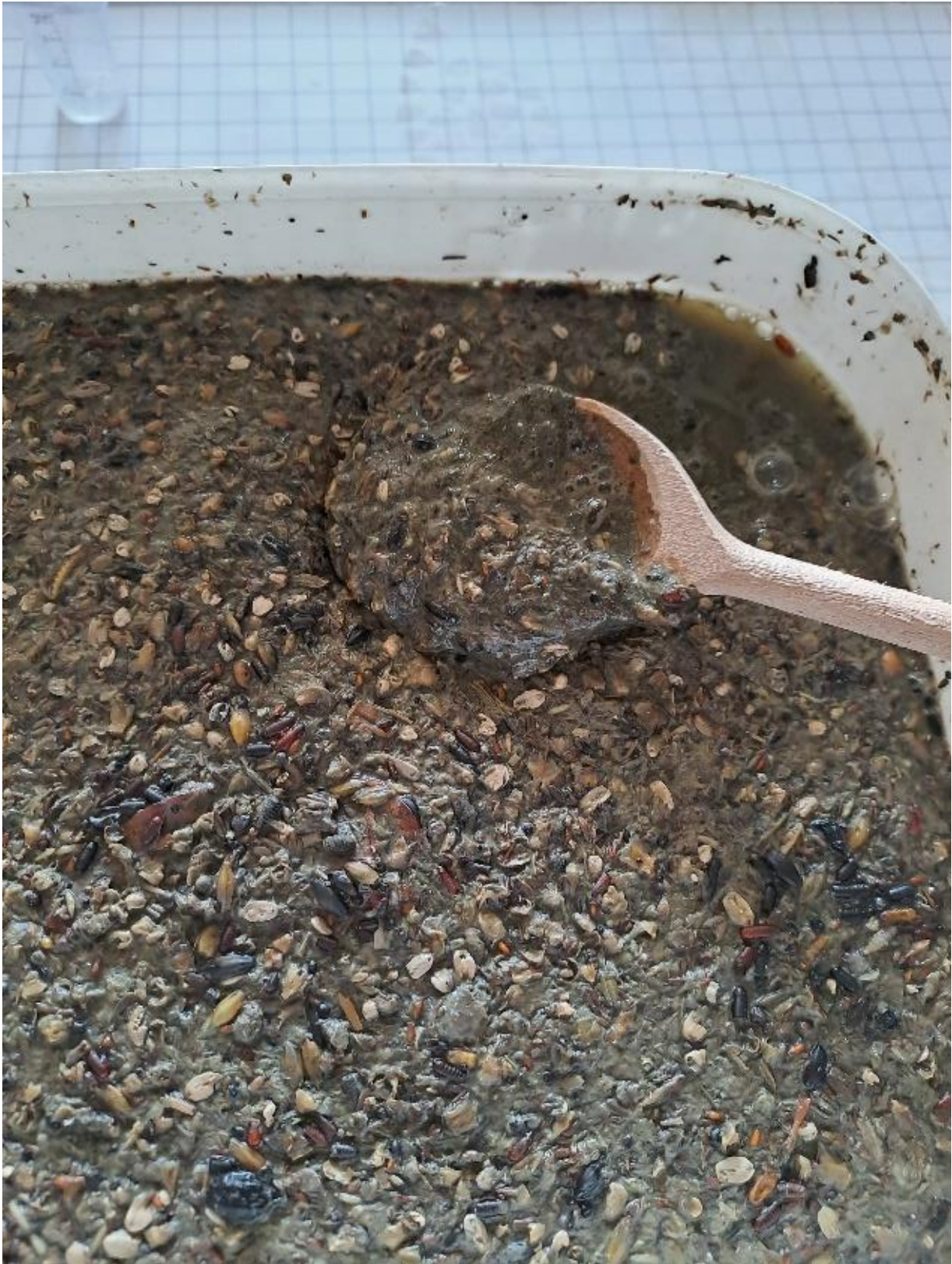
Abbildung 20: Schweinemast Rohgülle, Schwimmschicht mit unverdauten Futterrückständen ohne Reaktion
