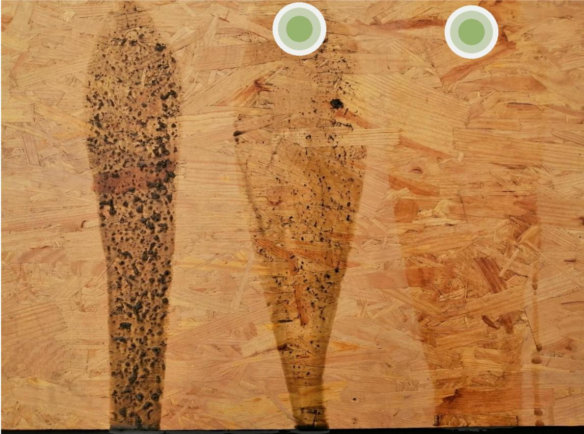
Abbildung 23: Abrinntest; Von links nach rechts: Rohgülle (2), PRG-Rottegülle (3) mit 7 Monaten Rottezeit, PRG-Rottegülle (4) mit 10 Monaten Rottezeit
