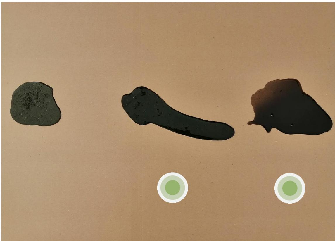
Abbildung 24: Zersetzungsstadien; Von links nach rechts: Rohgülle (2), PRG-Rottegülle (3) mit 7 Monaten Rottezeit, PRG-Rottegülle (4) mit 10 Monaten Rottezeit
