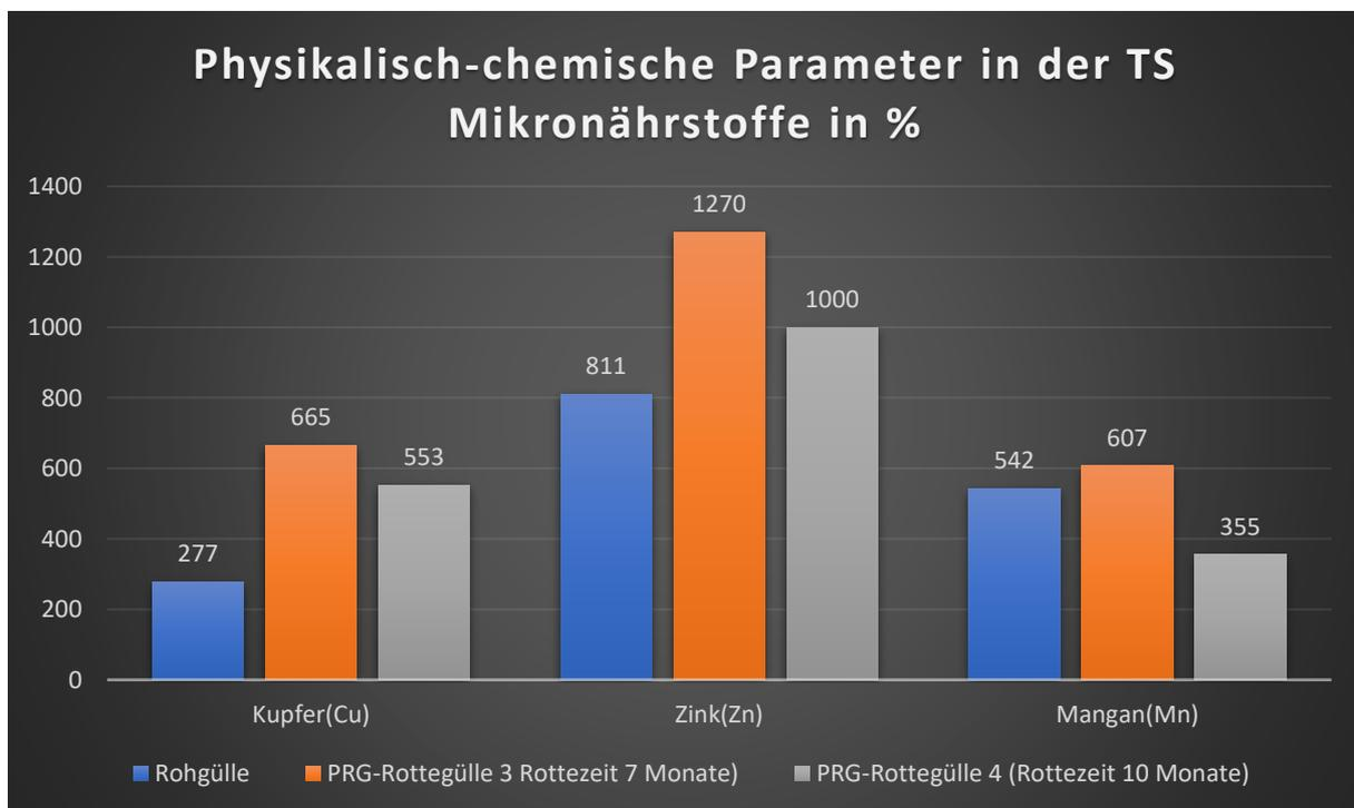
Abbildung 4: Physikalisch-chemische Parameter in der Trockensubstanz-Nachweisgröße in Prozent
