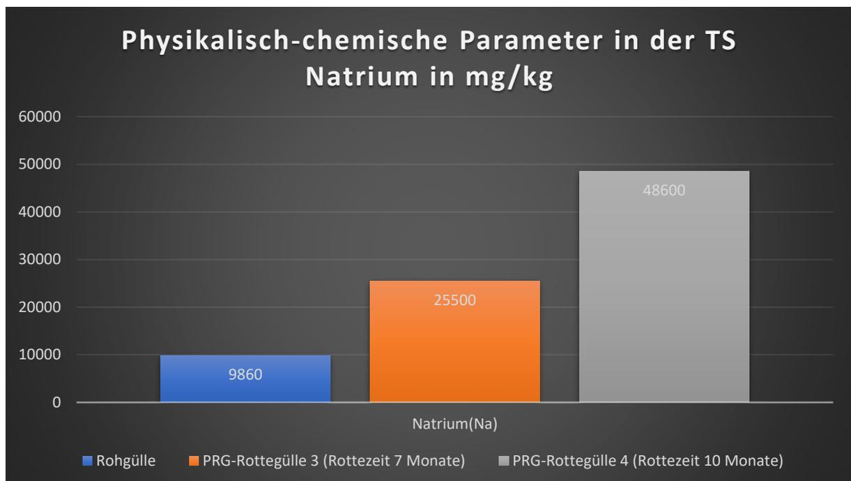
Abbildung 8: Physikalisch-chemische Parameter in der Trockensubstanz-Nachweisgröße in mg/kg
